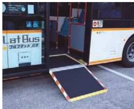
▲車いすスロープ
