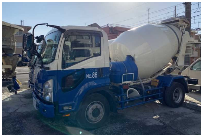
車両名:生コンクリート車 生コンクリートを打設する際に使用します。
