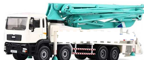
コンクリートポンプ車
