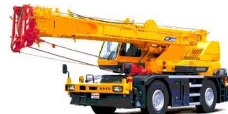
ラフタークレーン
