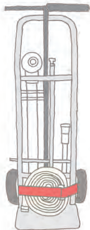
スタンドパイプ
