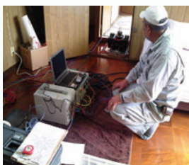
ビック動的診断測定状況
