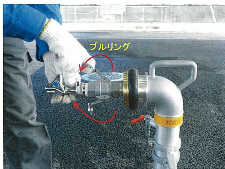
接続金具の挿し口に挿込んだ状態で、蛇口アダプター受け口のプルリングを水平にするまで引いて、しっかりと固定します。
